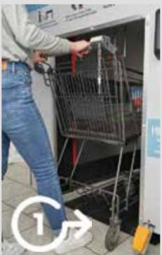
Über das Betätigen eines Fußschalters wird Desinfektionsmittel aus einem 15-Liter-Tank in mehrere Düsen gepumpt, die diesen dann in Form von Sprühnebel auf dem Einkaufshelfer verteilen.
