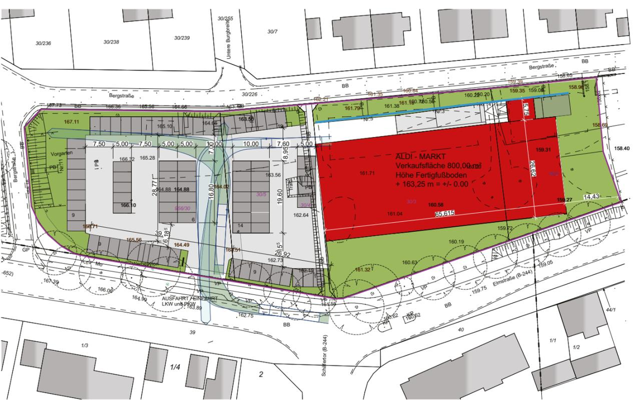
Aktueller Lageplan des Aldi-Marktes (rot) in der Elmstraße einschließlich Schallschutzwand (blau), erstellt durch die Firma Oliver Sens Architektur- und Ingenieurprojekte aus Haldensleben
