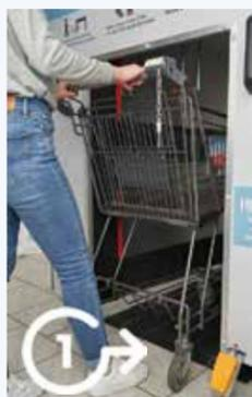
Über das Betätigen eines Fußschalters wird Desinfektionsmittel aus einem 12-Liter-Tank in mehrere Düsen gepumpt, die dieses dann in Form von Sprühnebel auf die Pflegehilfsmittel verteilen. Der Prozess der Befuchtung sollte mindestens drei Sekunden lang erfolgen.
