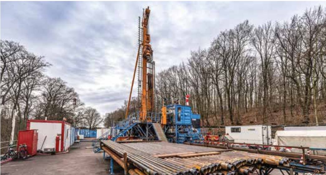
▲ Die Erkundungsbohrung Remlingen 18 hat den Salzspiegel erreicht. Dieser liegt in einer Tiefe von fast 500 Metern.
